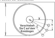
A = Trommeldurchmesser + Belag und Förderband C = Mögliche Position der Steckachse, falls Verschieben erforderlich
